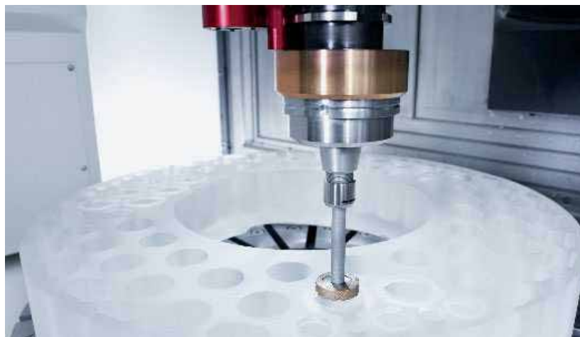
図 2. 光学レンズの超音波加工
